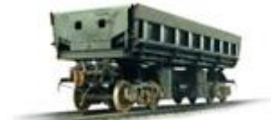
Вагон-самосвал (думпкар) (Модель: 31-945)
